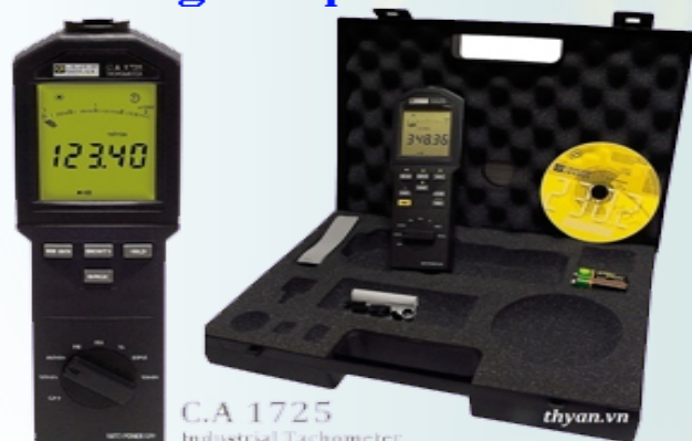
Máy kiểm tra chu kỳ tần số tốc độ động cơ
